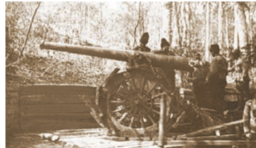
Photo 2: De Bange long cannon, 120 mm calibre, model 1878-1916
